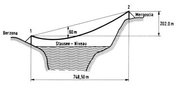
= 74 850 cm Horizontale Spannweite a Höhendifferenz der Aufhängepunkte h = 20 200 cm maximaler Durchhang bei 0° C und Zusatzlast = 6 000 cm
