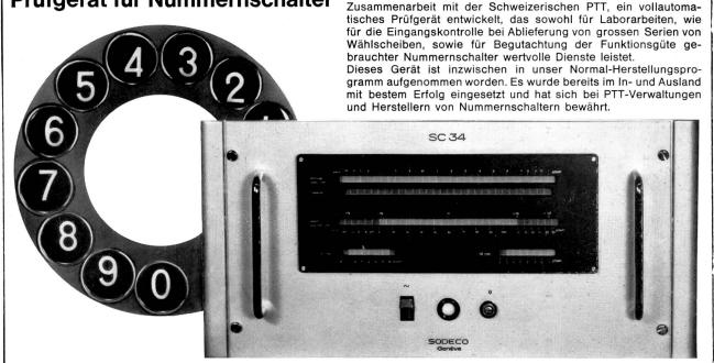
Automatische Messung der Gesamtablaufszeit von 10 Impulsen ● Messung der Dauer jedes einzelnen Impulses und automatische Berechnung der zulässigen Toleranzgrenzen ● Kontrolle der Hilfskontakte ● Leicht ablesbare Anzeige durch Leuchtfelder ● Hochpräzise Zeitmessung mit Quarzoszillator.
