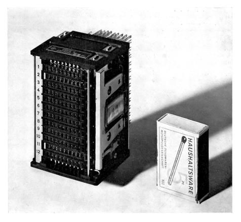
Fig. 8 Ordinaten-Haftschalter, bestückt mit 12imes9 Koppelpunkten
