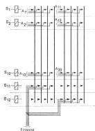
Fig. 7 Aufbau des Ordinaten-Haftschalters OHS (links) und Schaltung des OHS für 20 vieraderige Ausgänge (rechts)
