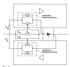
Fig. 3 Gleichstrom-Ersatzschaltung der unterirdischen Zwischenverstärker
