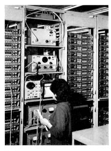
Fig. 10 Dauerprüfgestell für Trägerfrequenzeinschübe in der Fabrik Offenburg (Alle Bilder und Zeichnungen: Telefunken)
