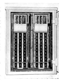
Wählsterneinrichtung 63 b zur Verbindung von 120 Telephonteilnehmern über 18 Leitungen mit der Zentrale
