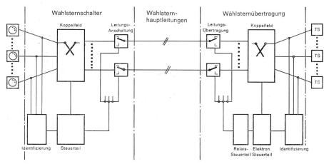
Fig. 5 Blockschema der Wählsterneinrichtung WStE 63 mit elektronischer Steuerung und Ordinaten-Haftschaltern
