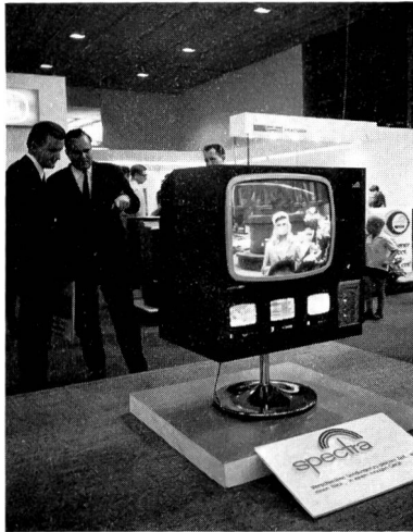
Fig. 2 Als besonderer Knüller zur Funkausstellung stellte Nordmende diesen Spezialempfänger für professionellen Gebrauch vor. Er enthält einen grossen Farb- und drei kleinere Schwarzweissmonitore, so dass zum Beispiel Kritiker bis zu vier gleichzeitig laufende Fernsehprogramme kontrollieren können
