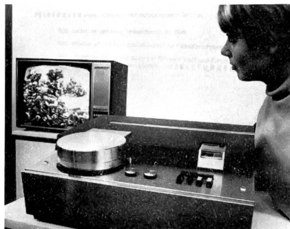
Fig. 5 Prototyp eines für den Heimgebrauch bestimmten magnetischen Bildaufzeichnungsgerätes. Die beiden Bandspulen sind übereinander angeordnet
