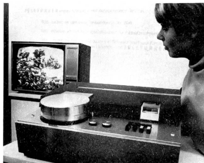
Fig. 5 Prototyp eines für den Heimgebrauch bestimmten magnetischen Bildaufzeichnungsgerätes. Die beiden Bandspulen sind übereinander angeordnet
