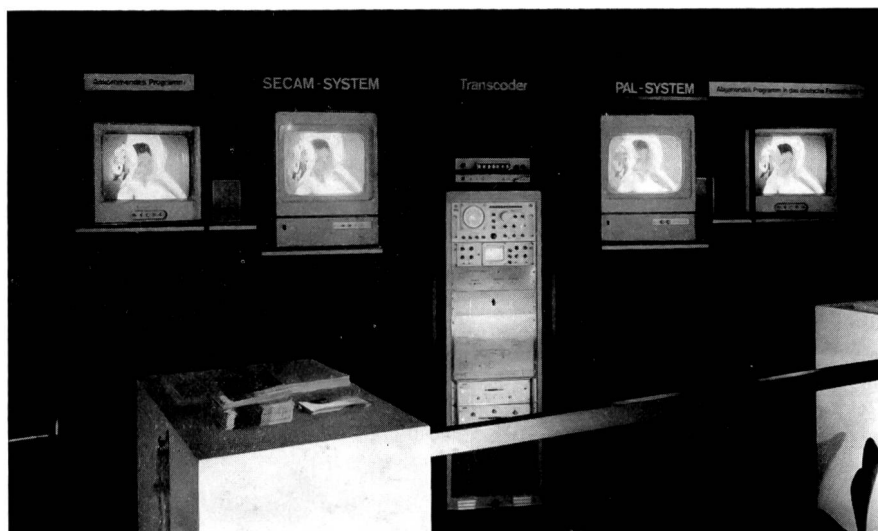
Fig. 10 Transcoder des Fernmeldetechnischen Zentralamtes (FTZ) Darmstadt, mit dem die Wandlung von Farbfernsehbildern aus dem SECAM- ins PAL-System gezeigt wurde
