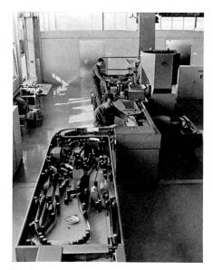
Fig. 1 Vue de l'installation pour le traitement automatique du courrier à l'office d'expédition des lettres de Lausanne 1; au premier plan, la redresseuse, au second, la séparatrice de formats
