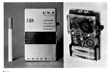
Taschendiktiergerät mit kleinsten Abmessungen (54×38×8 mm) und geringem Gewicht (280 g). Als Tonträger wird ein Vierfachspielband von 22 m Länge und 3,8 mm Breite in einer Spezialkassette verwendet, womit sich eine Aufnahmedauer von 2×10 min ergibt. Der Aufnahme-Wiedergabe-Verstärker ist dreistufig und wird durch einen integrierten Schaltkreis gebildet
