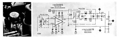
Fig. 8 Im Zuge der Modernisierung bewährter Schaltungstechnik zeigte Blaupunkt Fernsehgeräte mit integriertem Ton-ZF-Verstärker. In einem «Monolyth» von der Grösse eines Transistors (links) ist dieser integrierte Baustein enthalten, der im Schaltbild (rechts) als Dreieck dargestellt ist
