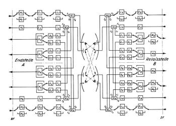
Schematische Darstellung eines Überhorizont-Richtfunksystems für 4×120 Gesprächskanäle mit teilweiser Gerätereserve
