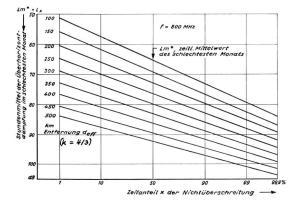
Zeitliche Verteilung des Überhorizontalverlustes in Abhängigkeit von der Überhorizontentfernung,  $Lm^* + L_x = f(x, d_{eff})$
