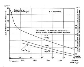
Fig. 4 Überhorizontverlust als Funktion des Scatterwinkels, Lm\* = f ( $\Theta$  bzw. d<sub>eff</sub>).
