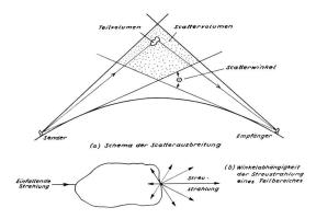
Fig. 2 Schematische Darstellung der Scatterausbreitung
