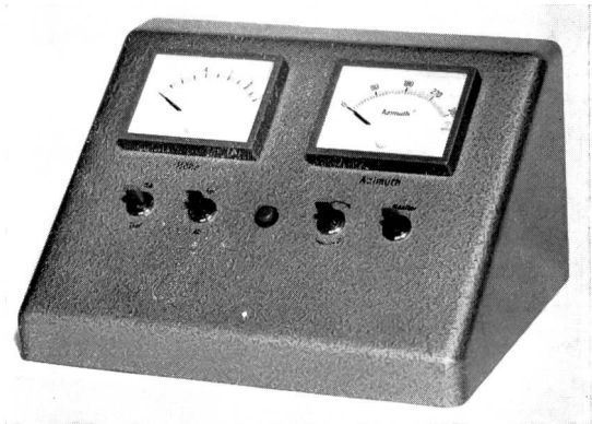
Fig. 10 Fernbedienungsgerät mit Anzeige der Masthöhe und des Azimuts
