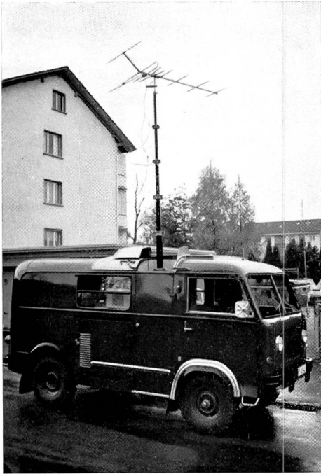
Fig. 1 Geländegängiger Messwagen mit teilweise ausgefahrenem Teleskopmast und montierter Dipolantenne
