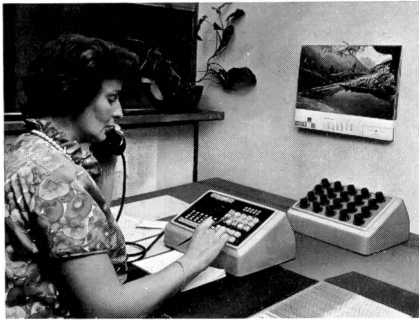
Fig. 5 Vermittlerstation einer automatischen Hauszentrale für 90...270 Nebenstellenanschlüssen von L. M. Ericsson
