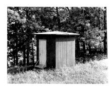
Fig. 10 Eines der Häuschen, wie sie in Schweden zahlreich für die automatischen Landzentralen mit höchstens 60 Anschlüssen verwendet werden
