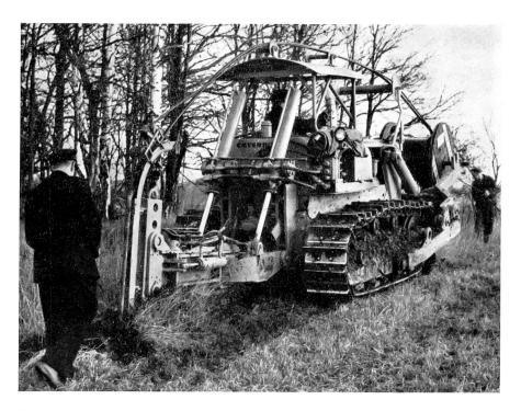
Fig. 18 Kabellegemaschine
