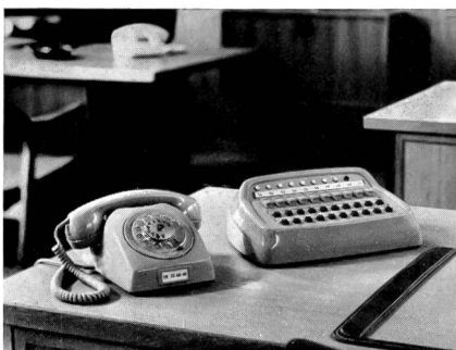
Fig. 7 Leitungswähler für 20 Nebenstellenanschlüsse und 8 Amtsleitungen (Intercom-System)
