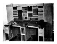
Fig. 12 Verkehrsüberwachungsplatz (links) und Prüfplatz für automatische Transitzentralen
