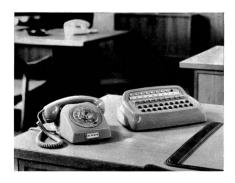
Fig. 7 Leitungswähler für 20 Nebenstellenanschlüsse und 8 Amtsleitungen (Intercom-System)
