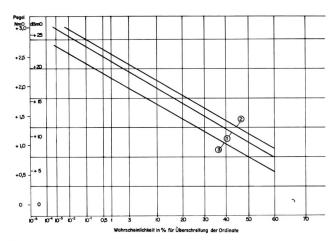
Fig. 7 Amplitudenverteilung der Belastung eines 6-MHz-Koaxialsystems 1 Mittelwert von 9 HVS
