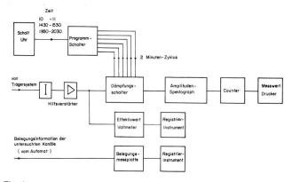
Fig. 1 Messanordnung zur Belastungs- und Belegungsmessung von Trägerfrequenzsystemen
