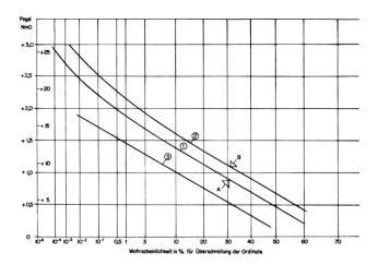
Fig. 6 Amplitudenverteilung der Belastung von drei Sekundärgruppen SG 6001, 6002, 6005 Bern-Zürich Mittel von 7 HVS Mittlerer Effektivwert A: +0,89 NmO Mittlere Belegung  $\overline{N}_B = 109$  Kanäle
