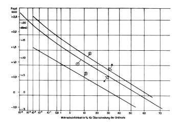
Fig. 5 Amplitudenverteilung der Belastung von Sekundärgruppen
