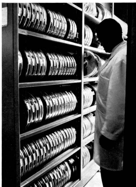
Fig. 8 Blick in die Kompaktanlage des Magnetbandarchivs, in dem auf 4000 Magnetbändern nahezu 60 Milliarden Daten (Zeichen) gespeichert werden können
