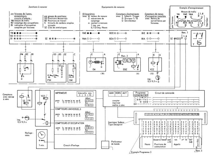
Fig. 2 Schéma simplifié de l'installation de mesure de trafic et de statistique pour le centre international de Genève
