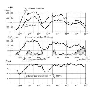
Fig. 3 Aperçu du déroulement de l'exploitation du central complet à l'aide du programme panoramique 3
