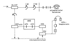
Fig. 20 Prinzipschema für die Behandlung von Assistance-Anrufen
