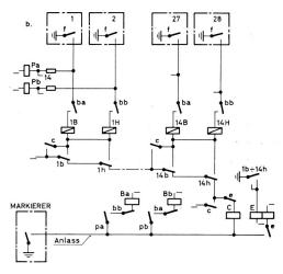
Fig. 27 Vereinfachte Prinzipschemata für Auswahlschaltungen
