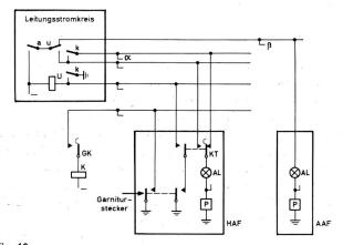
Fig. 10 Prinzipschema für den Betrieb der Anruflampen (AL) in den Frontausrüstungen der Schnurvermittlerplätze
