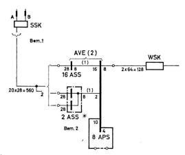
Fig. 24 Übersichtsschema für den Aufbau und die Zusammenschaltung der Anrufverteilelemente
