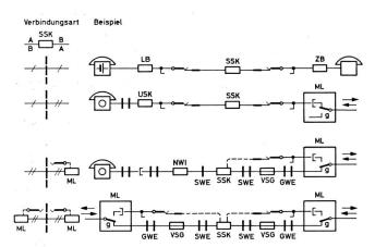
Fig. 8 Beispiele für Verbindungen, die mit Schnüren vermittelt werden. Abkürzungen siehe Fig. 3.
