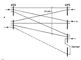
Fig. 25 Durchschaltemöglichkeiten im Anrufverteilelement, mit markierten, freien Schnurseiten in ASS (a) und markierten Wartestromkreisen (WSK) an APS (b). Ein Überlaufweg muss erst belegt werden, wenn alle  $z=a\times b$  Zwischenleitungen bereits belegt sind.
