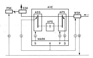
Fig. 26 Prinzipieller Ablauf eines Durchschaltevorganges über die automatische Anrufverteilung.
