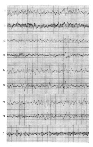
Fig. 1 Diagramme von Fahrzeugerschütterungen auf Strassen verschiedener Qualität. Kurve a zeigt jeweils den Geschwindigkeitsverlauf, Kurve b den Beschleunigungsverlauf. Papiervorschub: 12 cm/s
