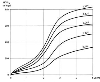
Fig. 4 Bildung von Perchlorsäure in Abhängigkeit von Zellenspannung und Batteriealter
