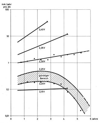
Fig. 6 Jährliche Zuwachsraten I' der Ladungserhalteströme für verschiedene Zellenspannungen (mA je Jahr und Ah)
