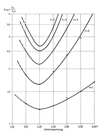
Fig. 5 Verlauf der relativen Ladungserhalteströme  $\mathbf{I_r}$  für verschiedene Batteriealter n in Jahren
