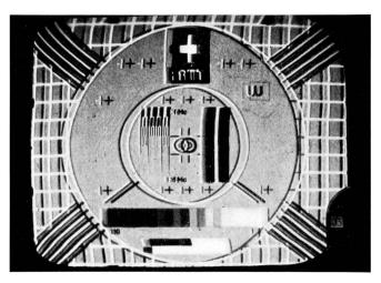
Fig. 5 Einstreubild und Vergleichsbild mit gleicher Signalstärke und entgegengesetzter Phase
