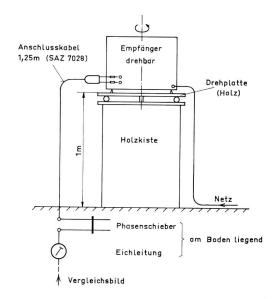
Fig. 1 Anordnung des Empfängers
