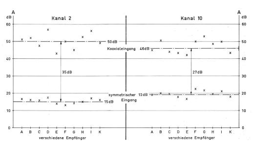
Fig. 6 Abschirmfaktor für Heimempfänger (einschliesslich Netzzuführung und Empfängeranschlusskabel)
