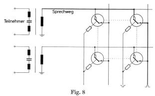
Matrice di connessione con transistori pnpn
