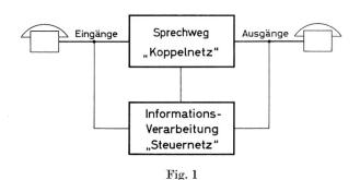
Principio d'un sistema automatico di commutazione
