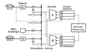
Fig. 10 Circuito TDM
