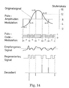
Processo di codificazione e di decodificazione nel sistema PCM
