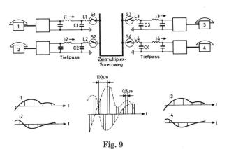
$\begin{array}{c} {\rm Trasferimento~a~risonanza~nel~sistema~di~multiplazione~a~divisione} \\ {\rm di~tempo} \end{array}$
