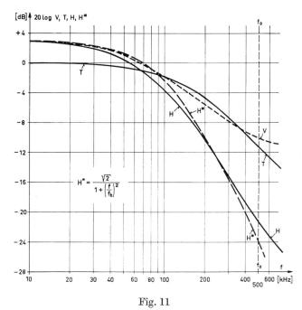
SECAM-III-System. Amplitudengänge der Nachbetonungen. V= videofrequente Nachbetonung; T= trägerfrequente Nachbetonung, auf Videobereich bezogen; H= Gesamtverlauf, angenähert durch  $H^*$ .  $f_0=$  Grenzfrequenz des videofrequenten Farbartsignals;  $f_h=$  Grenzfrequenz des Gesamtverlaufs der Nachbetonung = 110 kHz
