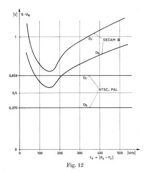
$\begin{array}{lll} \label{eq:continuous_product_state} Produkt \ aus \ Störabstand \ S \ und \ normierter \ Störspannung \ U_s \\ (Bezugsspannung \ s. \ Text) \ als \ Funktion \ der \ Störfrequenz \ f_s = \\ |F_s - F_c|. \ F_c = Farbträgerfrequenz; \ F_s = Störfrequenz \ am \ Eingang, \ f_s = Störfrequenz \ am \ Ausgang \ des \ Demodulators \\ (Diskriminators) \end{array}$
