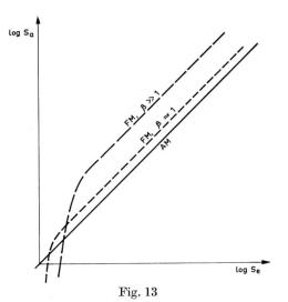
Störabstand am Ausgang des Demodulators (Diskriminators)  $S_a$  als Funktion des Eingangsstörabstandes  $S_e$  bei Amplituden (AM)- und Frequenzmodulation (FM).  $\beta =$  Modulationsindex
