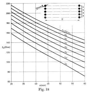
Impédance caractéristique d'une ligne à 10 fils Câble 19×1,4 mm  $\triangleq$  7,0 mm  $\varnothing$
