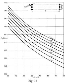
Impédance caractéristique d'une ligne à 6 fils Câble  $19 \times 1,4$  mm  $\triangleq 7,0$  mm  $\varnothing$
