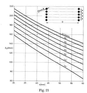
Impédance caractéristique d'une ligne à 10 fils Câble  $19 \times 1,5$  mm  $\triangleq 7,5$  mm  $\varnothing$
