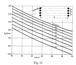
Impédance caractéristique d'une ligne à 8 fils Câble  $7\times1,7$  mm  $\triangleq 5,1$  mm  $\varnothing$
