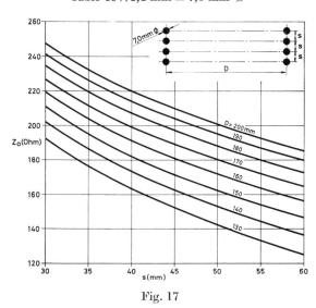
Impédance caractéristique d'une ligne à 8 fils Câble 19×1,4 mm  $\triangleq$  7,0 mm  $\varnothing$
