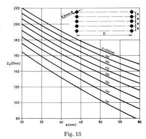
Impédance caractéristique d'une ligne à 10 fils Câble  $7 \times 2,1$  mm  $\triangleq 6,3$  mm  $\varnothing$
