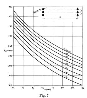
Impédance caractéristique d'une ligne à 6 fils Câble  $7 \times 1,5 \text{ mm} \triangleq 4,5 \text{ mm} \varnothing$
