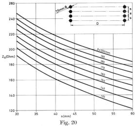
Impédance caractéristique d'une ligne à 8 fils Câble 19×1,5 mm  $\triangleq$  7,5 mm  $\varnothing$
