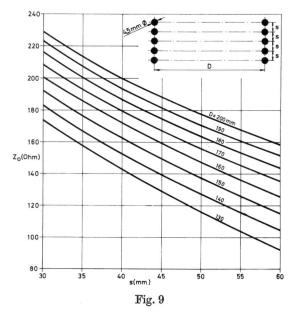
Impédance caractéristique d'une ligne à 10 fils Câble  $7\times1,5$  mm  $\triangleq4,5$  mm  $\varnothing$
