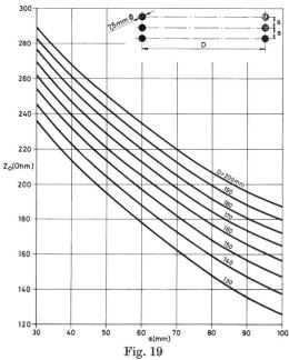
Impédance caractéristique d'une ligne à 6 fils Câble 19×1,5 mm  $\triangleq$  7,5 mm  $\varnothing$
