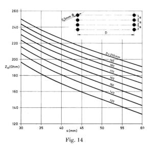
Impédance caractéristique d'une ligne à 8 fils Câble  $7\times2,1$  mm ^ 6,3 mm  $\varnothing$
