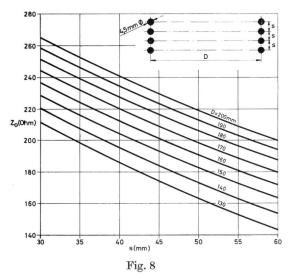
Impédance caractéristique d'une ligne à 8 fils Câble  $7 \times 1.5 \text{ mm} \triangleq 4.5 \text{ mm} \varnothing$
