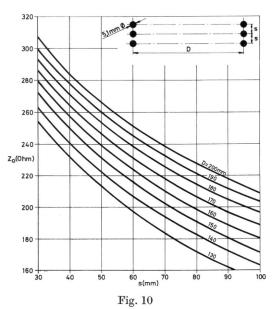
Impédance caractéristique d'une ligne à 6 fils Câble  $7{\times}1{,}7$ mm  $\triangleq 5{,}1$ mm  $\varnothing$
