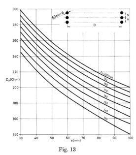
Impédance caractéristique d'une ligne à 6 fils Câble  $7\times 2,1$  mm  $\triangleq 6,3$  mm  $\varnothing$
