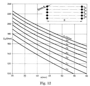
Impédance caractéristique d'une ligne à 10 fils Câble  $7{\times}1{,}7$ mm  $\triangleq5{,}1$ mm  $\varnothing$
