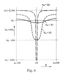
SECAM-III-System. Die der Farbart-Nutzkreisfrequenz  $\omega_v$  überlagerte momentane Störkreisfrequenz  $\Delta\Omega_m$  als Funktion des Winkels  $\beta$  zwischen Nutz- und Störträger auf einer Zeile der rechten Schirmhälfte im Zeitintervall  $\vartheta_m$ . Parameter: Relative Amplitude des asynchronen, störenden Farbartvektors. Fall  $\omega_u {>} \omega_v$ ; n= ungerade Zahl (vgl. Text)
