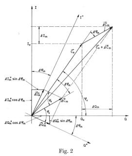
NTSC-System. Vektordiagramm des diskret echo-gestörten Farbartvektors für das Zeitintervall  $\vartheta_{\rm m}$  (vgl. Text)
