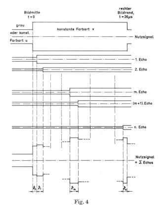
Das diskret echo-gestörte Farbartsignal beim SECAM-III-System. Überlagerung der Einzelechos auf einer Zeile der rechten Schirmhälfte (schematisiert)
