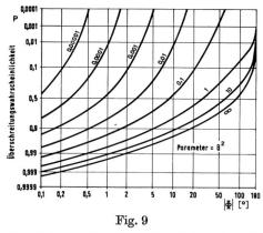
Verteilung des Betrages der Phase  $\Phi$  zwischen einem konstanten Nutzvektor  $\hat{1}$  und dem Summenvektor aus diesem und einem Rayleigh-verteilten Störvektor  $\hat{a}$ . Relative Störleistung =  $\hat{a}^2$
