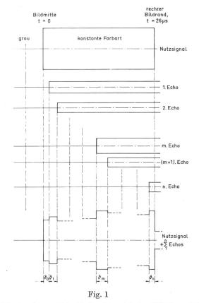
Das diskret echo-gestörte Farbartsignal beim NTSC- und PAL-System. Überlagerung der Einzelechos auf einer Zeile der rechten Schirmhälfte (schematisiert)
