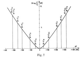
SECAM-III-System. Trägerfrequente Vorbetonung der Farbartsignale. Frequenzlage der Farbartsignale für Grund- und Komplementärfarben von 100% Sättigung und maximaler Leuchtdichte
