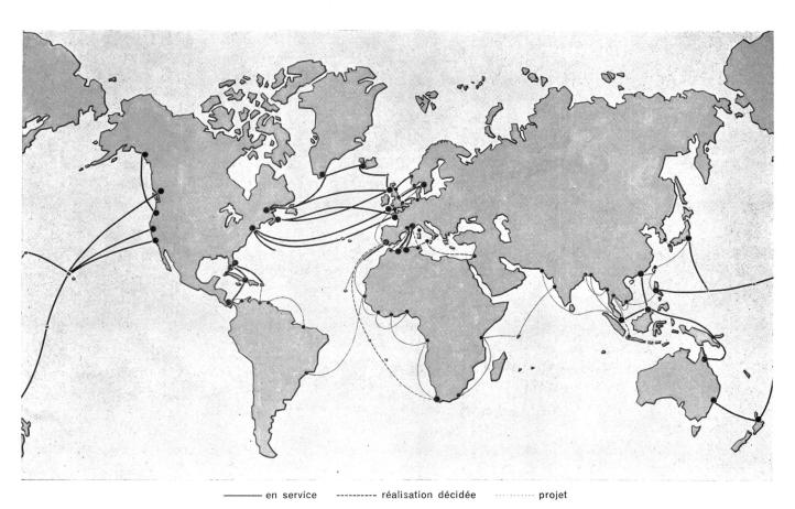
$\label{eq:Fig.2} \mbox{Fig. 2}$  Réseau des câbles téléphoniques sous-marins
