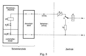
Prinzipielle Schaltung des Teilnehmerleitungs-Stromkreises Schéma de principe du circuit de ligne de poste
