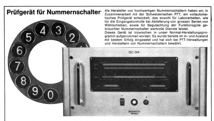
Automatische Messung der Gesamtablaufszeit von 10 Impulsen ● Messung der Dauer jedes einzelnen Impulses und automatische Berechnung der zulässigen Toleranzgrenzen ● Kontrolle der Hilfskontakte ● Leicht ablesbare Anzeige durch Leuchtfelder ● Hochpräzise Zeitmessung mit Quarzoszillator.
