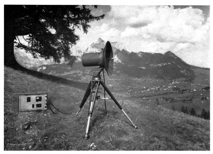
Modernes Richtstrahlsende-/Empfangsgerät für Mehrkanalübertragung im Frequenzband 6400...8000 MHz
