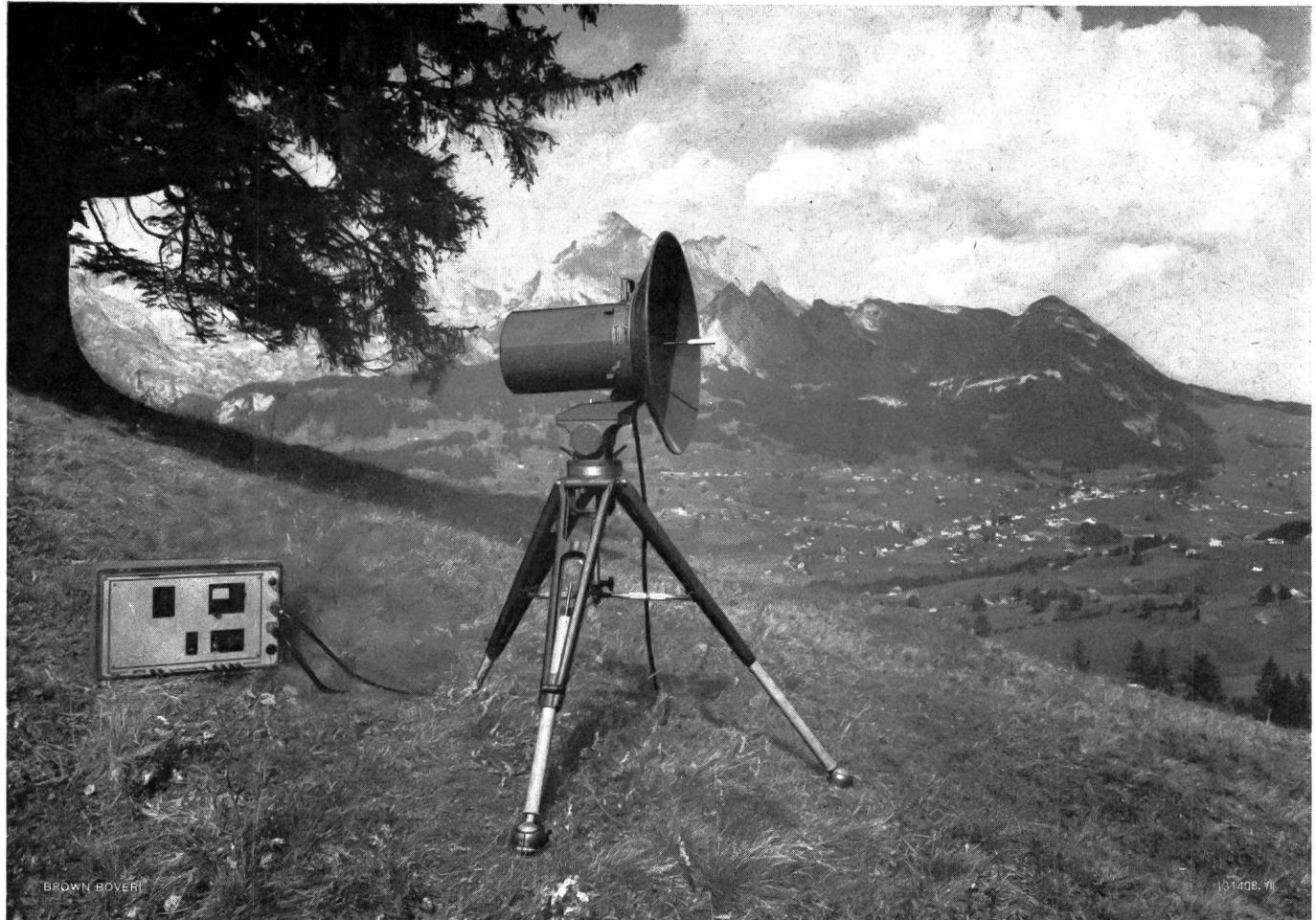
Modernes Richtstrahlsende-/Empfangsgerät für Mehrkanalübertragung im Frequenzband 6400...8000 MHz
