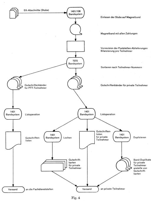
Schema delle operazioni di trattamento delle schede di versamento nel centro meccanografico PTT
