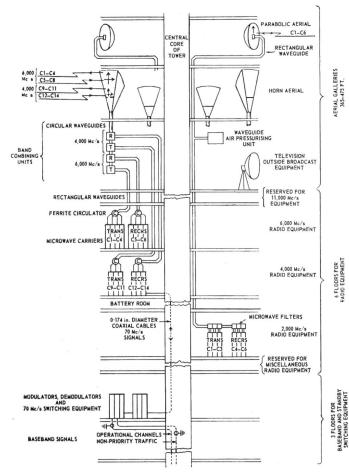
Fig. 7 Anordnung der Funkausrüstungen in der Mittelpartie des Turmes (vgl. dazu den Text)
