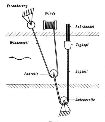
Fig. 5 Der Einzug des Rohrbündels
