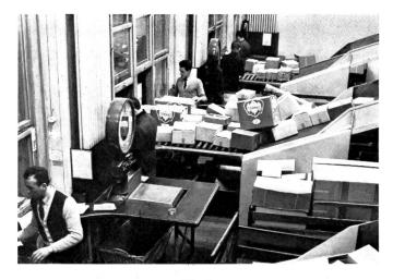
Paketannahme in der Sihlpost Zürich. Von den Massenschaltern gelangen die Pakete über Förderbänder unmittelbar zu den Sortieranlagen im Paketversand
