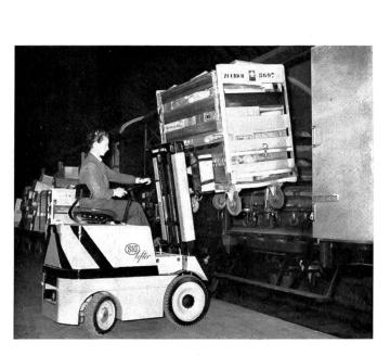
$\label{eq:Fig.4} F\"{u}r\ den\ Umladdienst\ in\ grossen\ Bahnh\"{o}fen\ werden\ Elektrolifter eingesetzt}$
