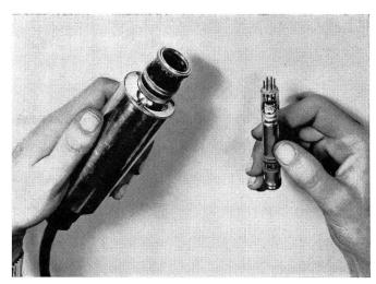
Fig. 4 Die Kleinst-Fernsehkamera «D» von EMI mit  $\frac{1}{2}$ -inch-Vidicon
