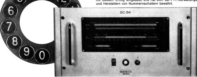
Automatische Messung der Gesamtablaufszeit von 10 Impulsen ● Messung der Dauer jedes einzelnen Impulses und automatische Berechnung der zulässigen Toleranzgrenzen ● Kontrolle der Hilfskontakte ● Leicht ablesbare Anzeige durch Leuchtfelder ● Hochpräzise Zeitmessung mit Quarzoszillator.
