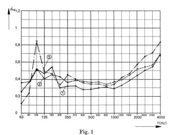
$\begin{array}{c} {\rm Coefficient~d'absorption~de~r\'esonateurs~\grave{\rm a}~membrane} \\ {\rm Influence~de~la~surface~de~la~membrane~sur~le~coefficient~d'absorption~pour~d~=~10~em} \end{array}$
