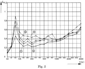
Coefficient d'absorption de résonateurs à membrane Influence d'un espace entre des résonateurs de  $60\times60$  cm et 10 cm de profondeur. Membrane en Pavatex mou de 12 mm. Intérieur revêtu de 4,5 cm de fibres de verre (Vetroflex IBR).
