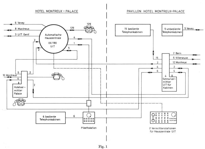
Verbindungsdiagramm der Telephonanlagen für die UIT-Konferenz 1965 in Montreux
