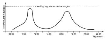
Fig. 2 Zeitlicher Anfall der Telephonverbindungen
