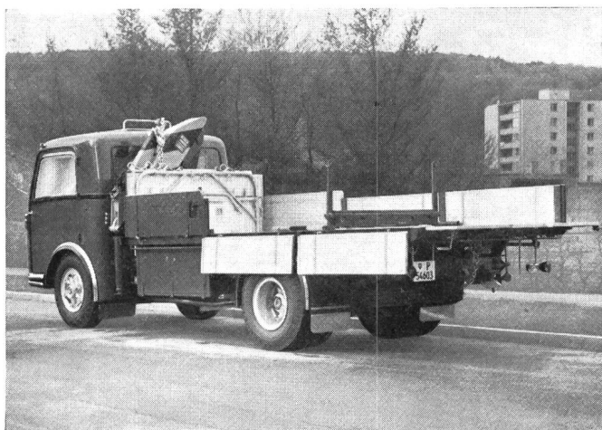
Fig. 5 Brücke mit Ladekran und Stangenlagerung Ponte con gru di caricamento e appoggio per pali
