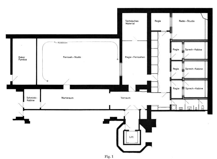
Grundriss des Aufnahmezentrums für Radio und Fernsehen im Parlamentsgebäude Plan du centre radiophonique et télévisuel dans le bâtiment du parlement
