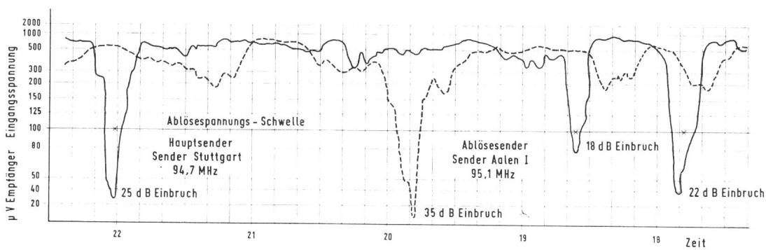
Verlauf der Eingangsspannung zweier sich ablösender UKW-Ballempfangssender
