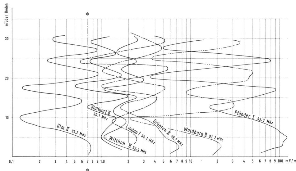
\* = Grenze der minimal erforderlichen Feldstärke für einen Geräuschabstand von  $\geq 50$  dB bei  $\geq 20$  dB Schwundeinbruch
