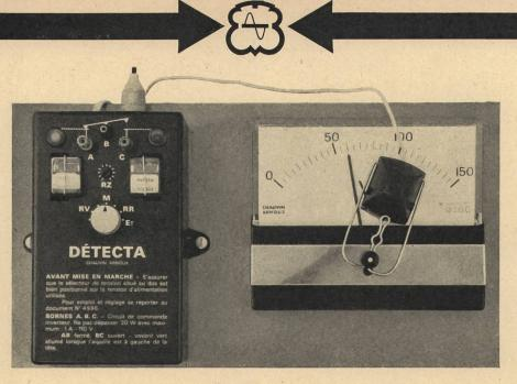
Photoelektrischer Zeigerwächter für Messinstrumente
