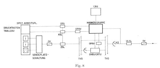
Markergruppe. Mit Hilfe der Markergruppe werden die Wähler eingestellt. Bei vorübergehender Speicherung im Überlaufspeicher (OVBS) erfolgt Vermittlungsdatenübertragung vom Arbeitsplatz in den zentralen Adressenspeicher (CAG).
