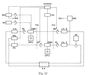
Automatischer Teilnehmer (AA). Einrichtung zur Kontrolle der Speicher. Lässt Prüftelegramm zwischen Eingangs- (IVBS) und Überlaufspeicher (OVBS) zirkulieren
