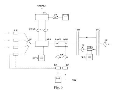
Zusatzeinheit zum Eingangsspeicher (AANV. IVBS). Bei fehlendem Endzeichen eines ankommenden Telegramms fügt der Namensender (NNZ) dieses hinzu. Zugleich wird die nachfolgende Meldung getrennt und erneut dem Zentraleneingang zugeleitet
