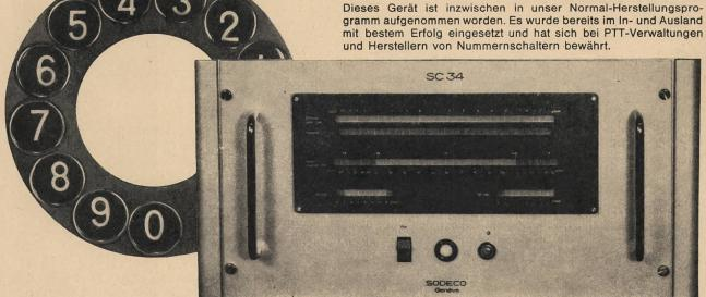
Automatische Messung der Gesamtablaufszeit von 10 Impulsen • Messung der Dauer jedes einzelnen Impulses und automatische Berechnung der zulässigen Toleranzgrenzen • Kontrolle der Hilfskontakte ● Leicht ablesbare Anzeige durch Leuchtfelder ● Hochpräzise Zeitmessung mit Quarzoszillator.
