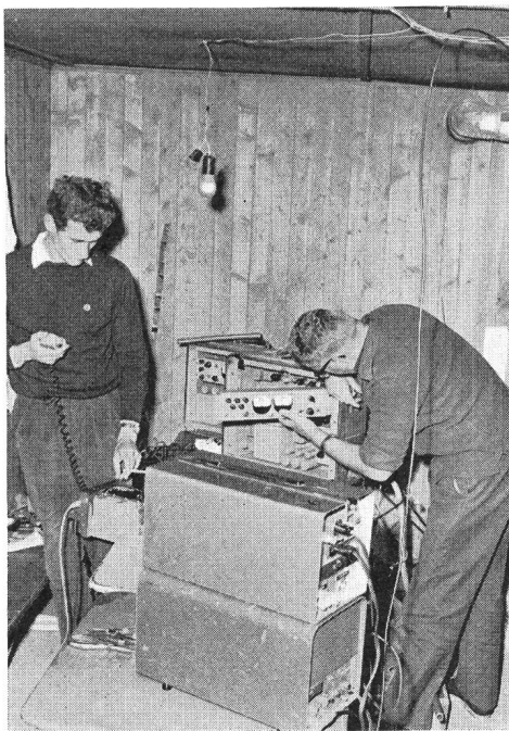
Fig. 7 7-GHz-Bildverbindung mit Kontrollgeräten und Radiotelephon im Skihaus Schwarzsee
