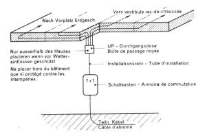
Durchgangsdose mit Trennklemmen Boîte à bornes avec ponts de coupure
