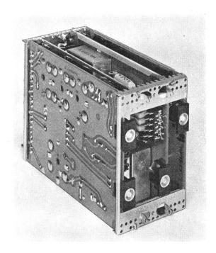
${\rm Fig.}~6$  Primärgruppenumsetzer und Verstärker (Senden)
