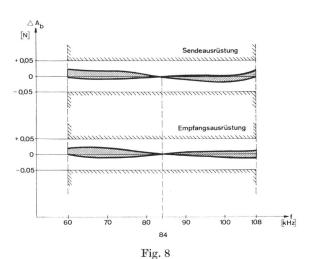
Streubereiche der Dämpfungsverzerrungen für Sende- oder Empfangsausrüstungen einzeln, gemessen als Betriebsdämpfungsschwankung bezüglich der Dämpfung bei der Gruppenpilotfrequenz
