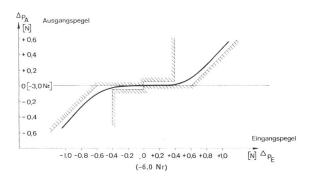
Fig. 15 Regelcharakteristik der Sekundärgruppenverstärker
