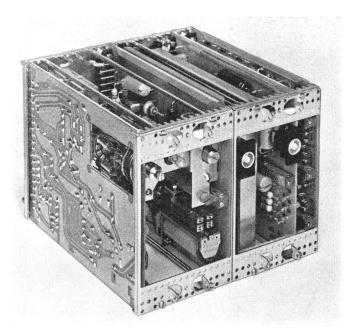
Fig. 18 Sekundärgruppenregulierverstärker und Pilotempfänger
