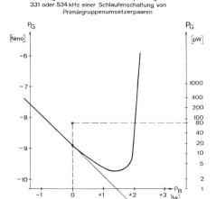
Gesamtgeräusch in einem Kanal in Funktion der Belastung mit weissem Rauschen. Beim Pegel  $P_B=0$  Nr wurde das 60-Kanalsystem mit einer totalen Geräuschleistung von + 1,2 Nm0 belastet. Dies entspricht:
