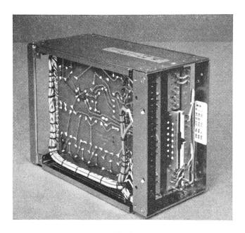
${\bf Fig.~9}$  Kanaleinheit – Geräteeinschub
