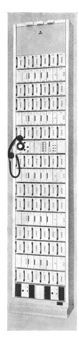
Fig. 11 Ansicht eines FU-Gestells mit 60 Kanälen
