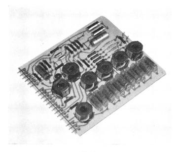
Fig. 8 Vorgruppenmodulator mit Filter und Verstärker
