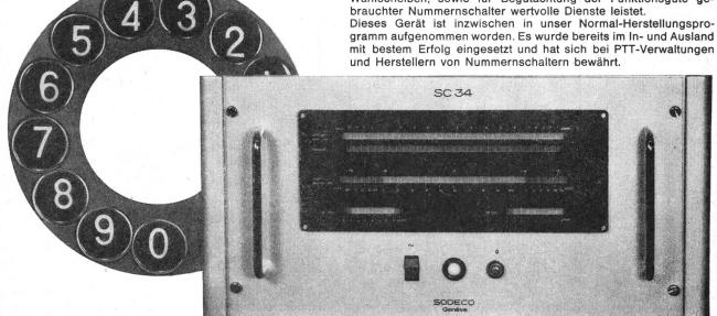
Automatische Messung der Gesamtablaufszeit von 10 Impulsen • Messung der Dauer jedes einzelnen Impulses und automatische Berechnung der zulässigen Toleranzgrenzen 9 Kontrolle der Hilfskontakte ● Leicht ablesbare Anzeige durch Leuchtfelder ● Hochpräzise Zeitmessung mit Quarzoszillator.
