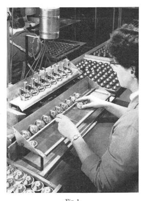
Einfüllen von Kohlepulver in Mikrophonkapseln. Einfüllmenge Verdrahten von Linienwählerstationen für die schweizerischen je Kapsel etwa 0,17 g
