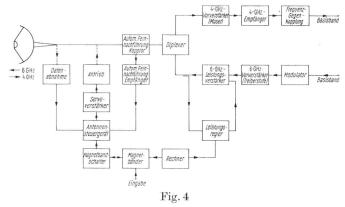
Blockschema der Steuerungseinrichtungen sowie der Sende- und Empfangsgeräte der Antenne I
