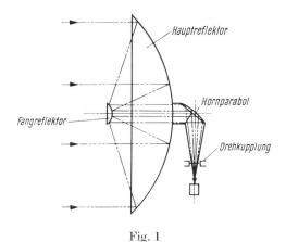
Prinzip der Cassegrin-Antenne mit Hornparabolspeisung
