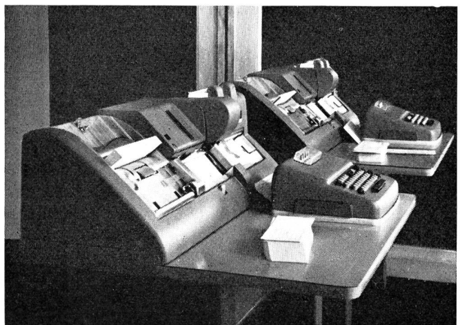
Fig. 4 IBM-Schreiblocher zur Herstellung der Lochkarten (gemäss Fig. 2)
