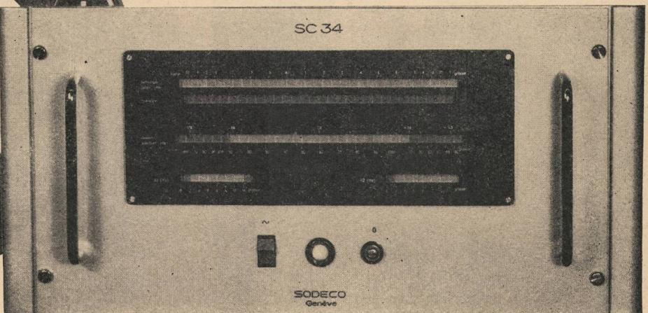
Automatische Messung der Gesamtlaufzeit von 10 Impulsen • Messung der Dauer jedes einzelnen Impulses und automatische Berechnung der zulässigen Toleranzgrenzen • Kontrolle der Hilfskontakte • Leicht ablesbare Anzeige durch Leuchtfelder • Hochpräzise Zeitmessung mit Quarzoszillator.
