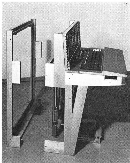
Fig. 7. Châssis en bois utilisé pour rangées simples
