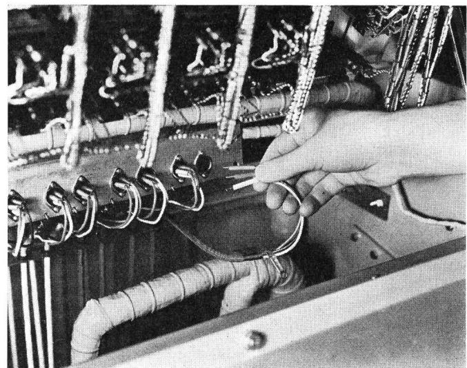
Fig. 13. Raccordement des cordons au moyen des fiches
