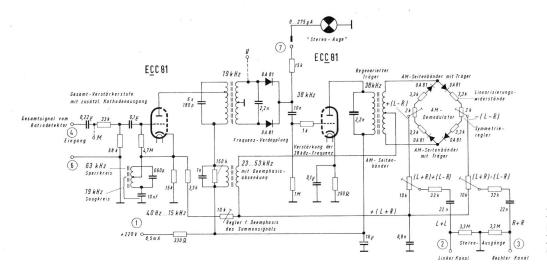
Fig. 1. Gesamtschaltbild eines Stereo-Decoders (Decoder IV von Grundig)
