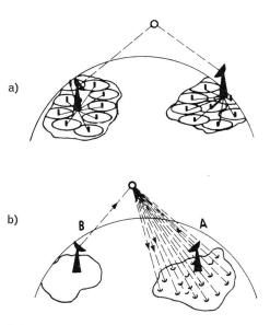
Fig. 1. Schema einer Radio- oder Fernsehsatellitenübertragung, a) Schwache Satellitensender und geringe Satelliten-
