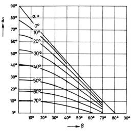
Fig. 4. Grösse des Winkels  $\delta$  des Satelliten über dem Horizont in Abhängigkeit vom Längengradunterschied  $\beta$  der Satellitenposition und dem Empfangsort.  $\alpha$  ist der Breitengrad des Empfangsortes
