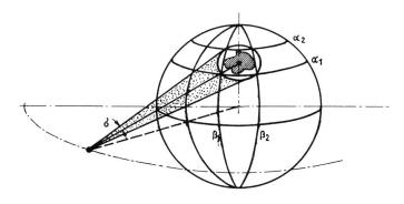
Fig. 2. Alleinige Bestrahlung des Versorgungsgebietes durch scharfe Bündelung des Satellitensenderstrahls
