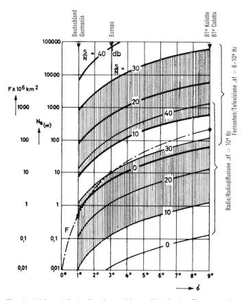
Fig. 3. Abhängigkeit der bestrahlten Oberfläche F sowie der dazu notwendigen Senderleistung  $N_s$  vom Richtstrahlwinkel  $\sigma$  bei Radio- bzw. Fernsehübertragung. Bandbreiten  $\Delta f = 10^4$  bzw. 6.106 Hz. S/N (dB) als Parameter ist ein Mass für die Empfangsgüte Dipendenza della superficie coperta F e della potenza
