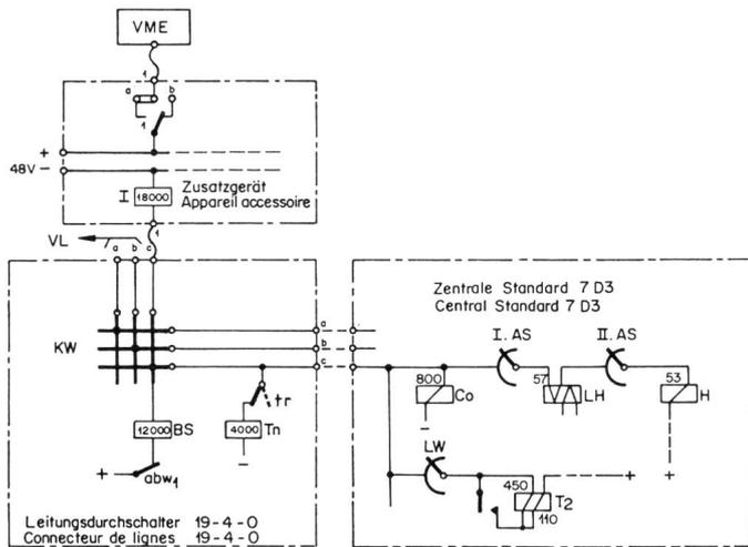
Fig. 13a. Prinzip der Verkehrsmessung einer LD-Anlage angeschlossen an einer Telephonzentrale Bell-Standard 7D
