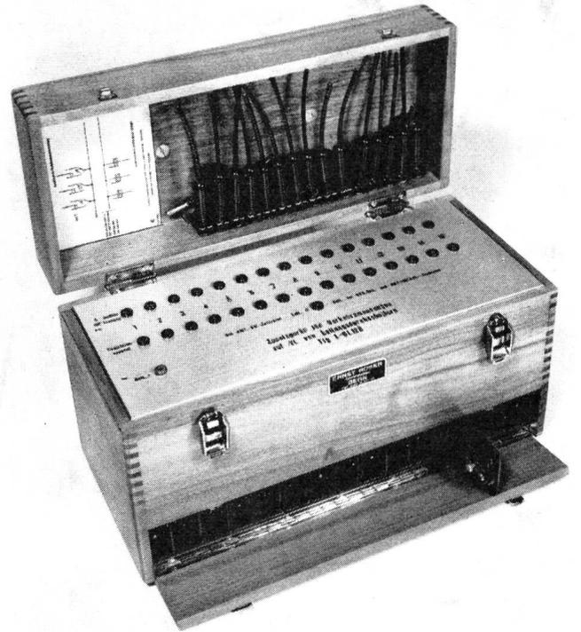
Fig. 14. Ansicht des Zusatzgerätes für Verkehrsmessungen
