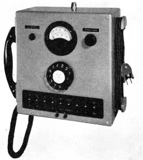
Fig. 8. Ansicht des Prüfkastens für Leitungsdurchschalter
