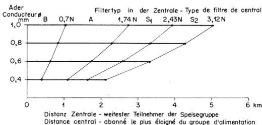
Fig. 2c. Reichweite der Zentralenfilter für Umgehungsschaltung I/19
