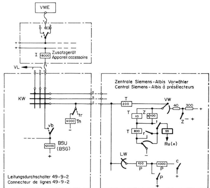
Fig. 13b. Prinzip der Verkehrsmessung einer LD-Anlage angeschlossen an einer Telephonzentrale Siemens VW-LW
