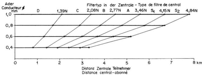
Fig. 2a. Reichweite der Zentralenfilter für Einzelanschlüsse
