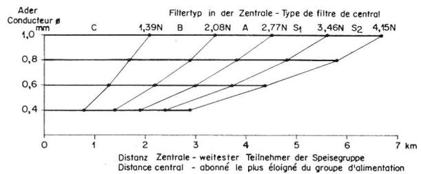
Fig. 2b. Reichweite der Zentralenfilter für Umgehungsschaltungen II/8 und IV/16
