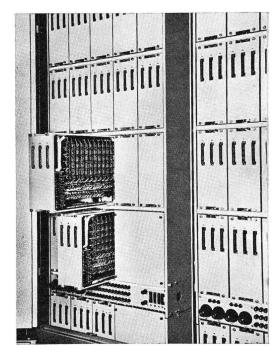
Fig. 2. Die Koppelrahmeneinschübe sind als steckbare Baugruppen ausgebildet
