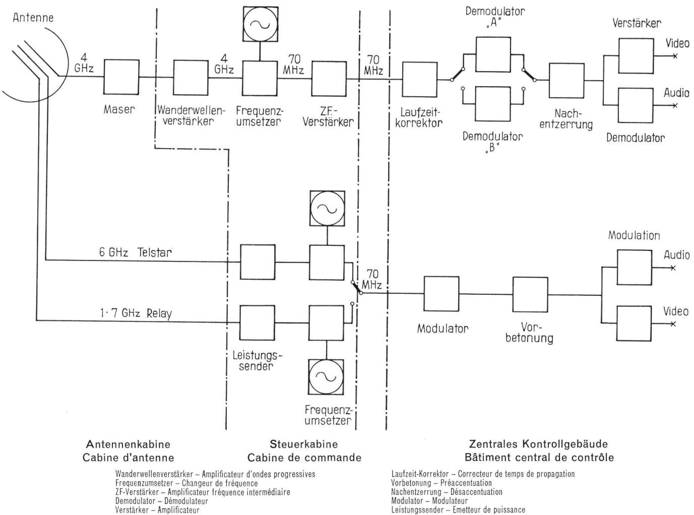
Fig. 4. Blockschema der Übertragungsausrüstung von Goonhilly Downs
